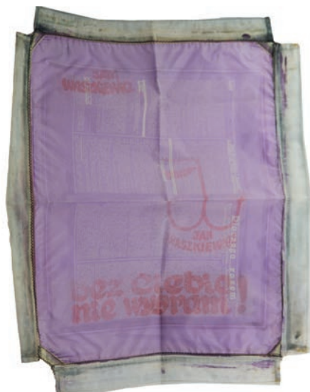
Il. 12. Matryca ze stronami 2-3 pisma „Z dnia na dzień” nr 28/510 na tzw. ramkę wrocławską. Dar anonimowy, Archiwum Ośrodka „Pamięć i Przyszłość”, sygn. AKC/6532.
